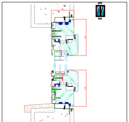
SECCIÓN VERTICAL, VENTANA ES- TANDAR 76 COPLANAR, SISTEMA MEMI SIN TAPAJUNTAS
