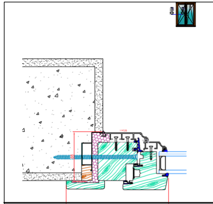
SECCIÓN HORIZONTAL, VENTANA
